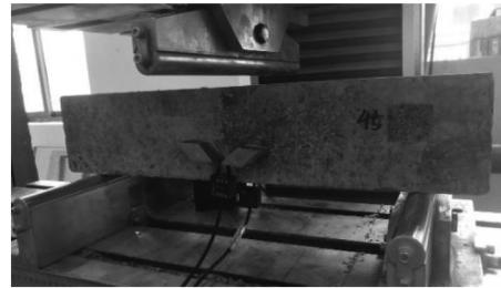
图1 加载装置
