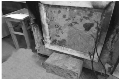
图2 混凝土板高温渗水图
