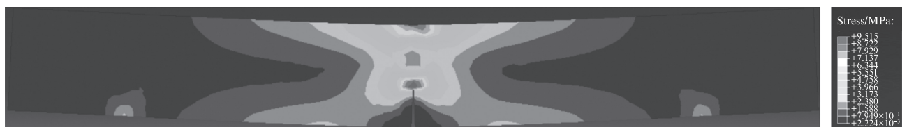
图5 10 mm裂缝应力场云图
