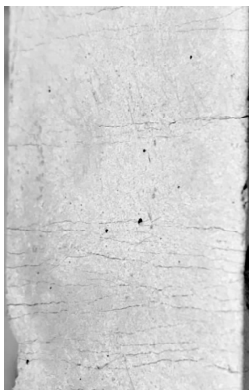
图2 HVFA-SHCC试件多裂缝开展现象
