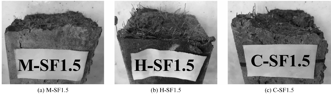
图 4 SFHLAC 试件弯折试验后的断面图
