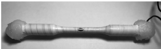
图 2 预处理的钢筋试件 Fig. 2 Pretreated steel bar specimen
