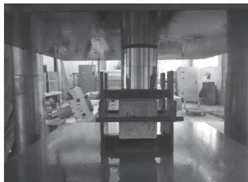
图3 试件劈裂加载示意图
