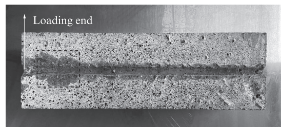
图11 拔出后混凝土的破坏形态 Fig. 11 Damage pattern of concrete
